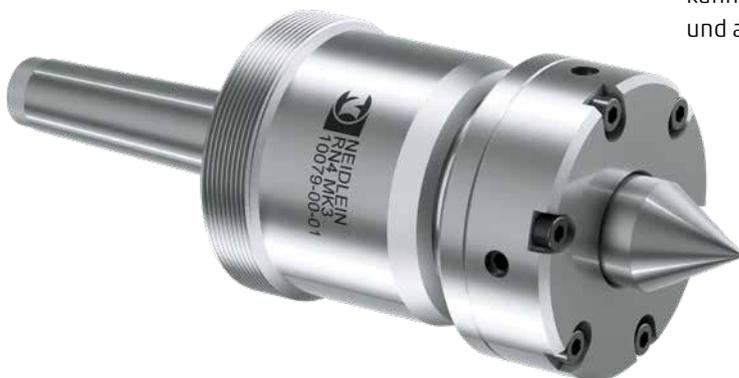
Diese Rollspitze wurde dafür konzipiert die Zentrierspitze radial zu justieren. Zum Einen können exzentrische Werkstücke auf  $\pm 1$  mm aus der Mitte ausgerichtet werden und zum Anderen kann die Zentrierspitze auf ca.  $1 \mu$  Rundlauf Genauigkeit justiert und ausgerichtet werden.
