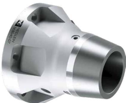
Für den Einsatz beim Schleifen und sonstigen Hartbearbeitungen. Über den hochgenauen HM-Innenkegel werden Werkstücke durch die Anpresskraft mitgenommen.
