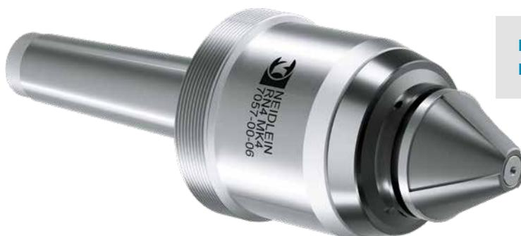
Diese Rollspitze zeichnet sich durch einen speziell angefertigten, pilzförmigen Hartmetall-Rotor aus, welcher durch Stege eine 3-Punkt-Auflage der Werkstücke gewährleistet.
