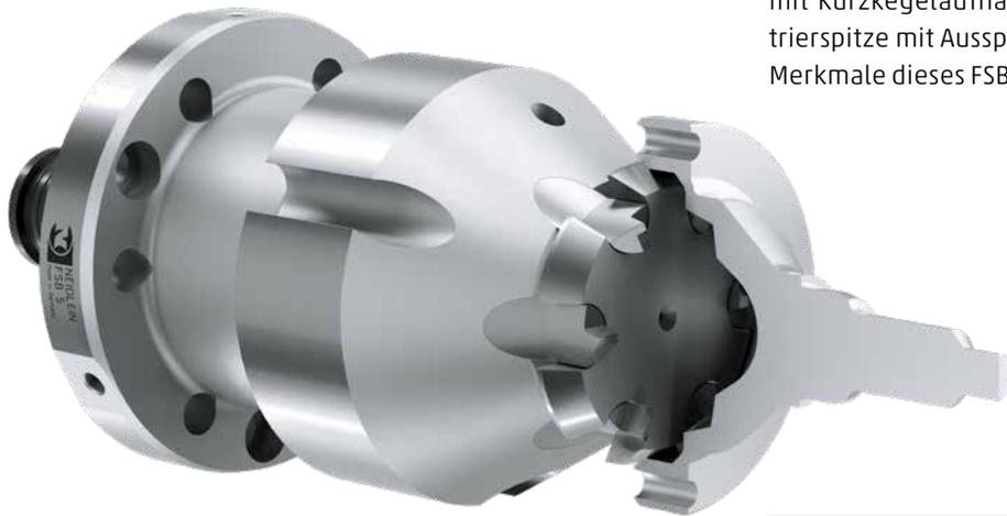
Der zur Gewichtsreduktion abgesetzte und verlängerte Flansch mit Kurzkegelaufnahme und die spezielle pilzförmige Zentrierspitze mit Aussparungen für die Mitnahmebolzen sind die Merkmale dieses FSB Stirnmitnehmers.
