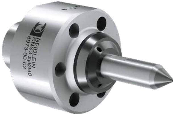
Diese Rollspitze wurde nach Kundenvorgabe konstruiert und zeichnet sich durch Sperrluftanschluss, Flanschaufnahme und Drehzahlüberwachung mittels Schlüsselfläche aus.
