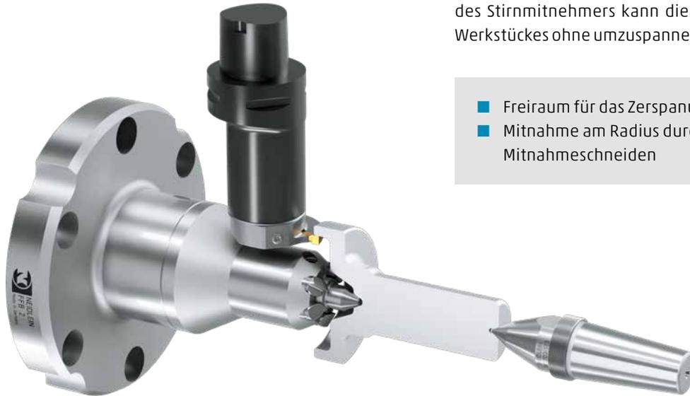
Durch die zylindrisch abgesetzte und verlängerte Ausführung des Stirnmitnehmers kann die Außen- und Innenkontur des Werkstückes ohne umzuspannen komplett bearbeitet werden.
