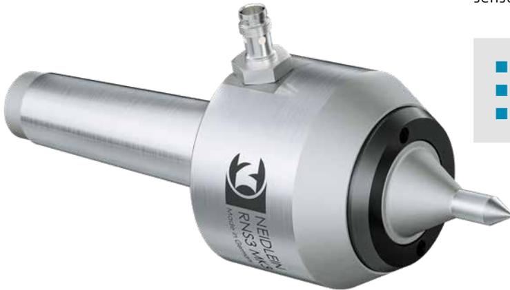
Für eine prozesssichere Überwachung der Werkstückrotation. Bei einer auftretenden Kollision erkennt dies der Drehzahlsensor der Rollspitze und stoppt die Maschinenspindel sofort.
